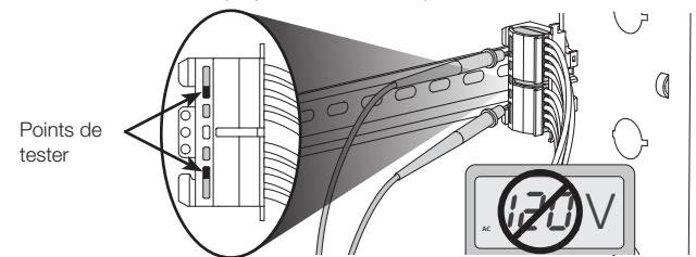
Installez les modules sur le côté droit de chaque rangée. Les connecteurs à 5 positions et les supports peuvent être démontés de la rangée du rail DIN mais ne doivent pas être jetés pour permettre leur utilisation ultérieure. Chaque DPM commande jusqu'à 4 charges.
