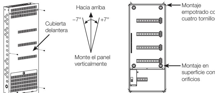
**3. Monte el panel para embutir utilizando uno de los siguientes métodos (no se suministra la tornillería de montaje):**
