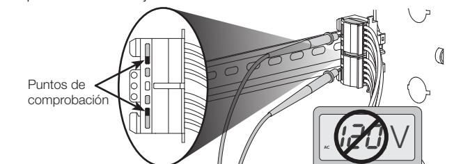
Instale los módulos en el lado derecho de cada fila. Los conectores de cables y los soportes de cinco posiciones pueden retirarse de la fila del riel DIN pero no deben desecharse para que estén disponibles para uso futuro. Cada DPM controla hasta cuatro cargas.
