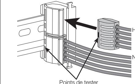
Les connecteurs de fils à 5 positions distribueront l'alimentation à chaque charge et ne doivent pas être retirés jusqu'à ce que toutes les charges aient été entièrement testées. Mettez l'alimentation sous tension aux emplacements des DPM. Vérifiez que tout l'éclairage connecté est alimenté. Si un disjoncteur se déclenche, il convient de corriger une erreur de câblage.
