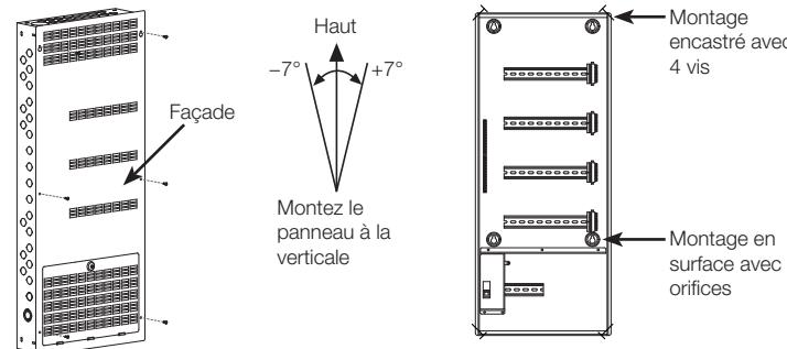
**3. Montez le panneau de raccordement** à l'aide de l'une des méthodes suivantes (le matériel de montage n'est pas fourni) :
