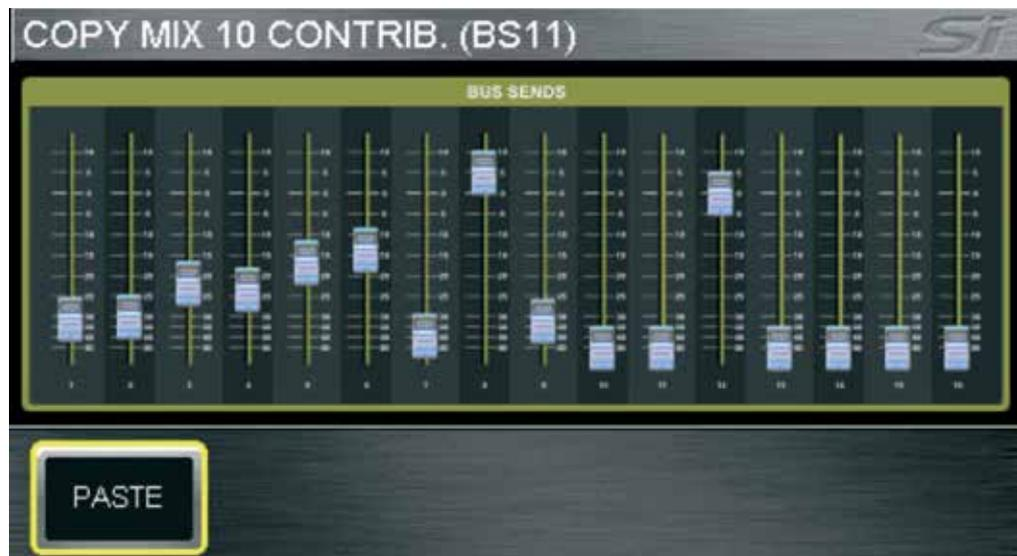
**Austauschen der Lexicon-Einstellungen zwischen Prozessoren:** Nach Drücken der FX-Taste im COPY & PASTE-Modus erscheinen die Symbole aller Lexicon-Prozessoren. Durch Berühren eines der Symbole wird der Quellprozessor ausgewählt. Zum Übertragen wird die PASTE-Taste gedrückt und gehalten, während die FX'n'-Tasten der Zielprozessoren gedrückt werden.
