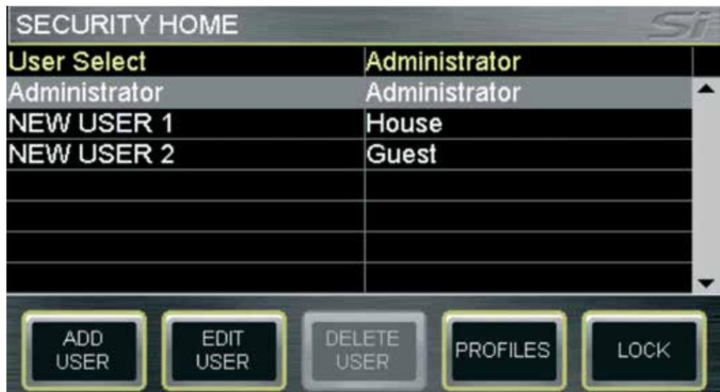
Mit dieser Funktion können einige oder alle Funktionen der Konsole gegen versehentlichen oder vorsätzlichen Mißbrauch geschützt werden. Alle Konsoleinstellungen lassen sich zu jeder Zeit einfach durch das Drücken der LOCK-Taste im SECURITY-Menü sperren.
