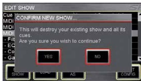
**LOAD:** Sie bewirkt das Laden einer neuen Show von der internen MultiMedia Karte (MMC-SD Karte) oder dem USB-Key, falls er installiert ist. Der SCROLL/ADJUST-Drehregler wird zum Navigieren durch das Speichermedium und die Dateistruktur für die Auswahl der Datei genutzt, die geladen werden soll. Das System zeigt eine Warnung an, dass diese Aktion die momentan geladene Show überschreibt und erlaubt das Abbrechen der Aktion.
