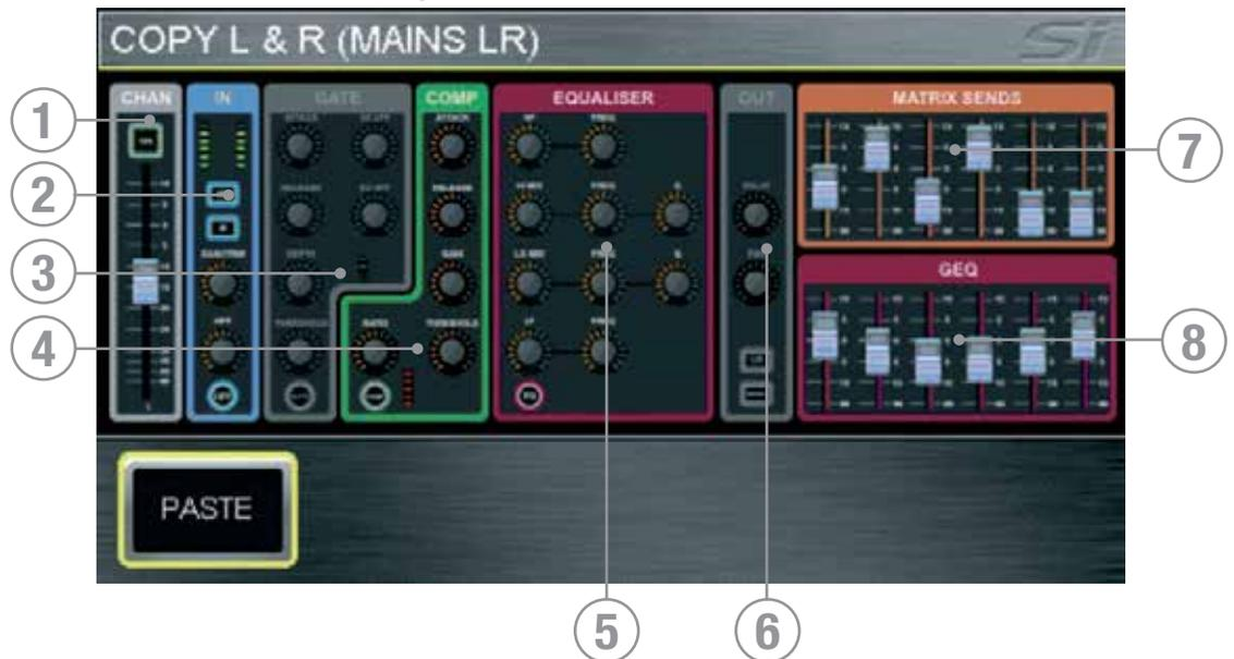
**Kopieren eines Kanals oder Busses:** Zunächst wird ein Quellkanal oder -bus mit SEL ausgewählt und alle Änderungen durchgeführt, bevor COPY & PASTE gedrückt wird. Das Drücken der COPY & PASTE-Taste kopiert alle Parameter des aktuell mit SEL ausgewählten Kanals oder Busses in die Zwischenablage:
