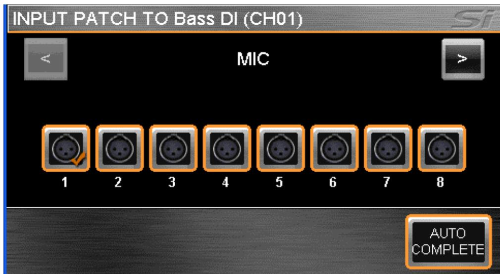
Zur automatischen Zuordnung mehrerer Kanäle wird die AUTO COMPLETE-Taste gedrückt. Dadurch erhöht sich der Eingang um 1 und die Zuordnung um 1, bis eine logische Gruppe vollständig zugeordnet ist.; Siehe "Auto Complete Gruppen/Boundaries" für weitere Informationen.
